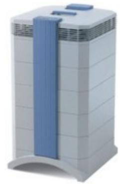
Funcionamiento del sistema IQAir: el aire entra en el sistema a través de las dos aberturas de la base y pasa por un pre-filtro y a continuación por el HEPA para partículas. El ventilador centrífugo genera un volumen de aire que es impulsado a través de los cartuchos. Se retienen las partículas de abrasión en los filtros de gas y el difusor devuelve el aire a baja velocidad a la habitación.
